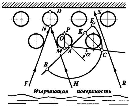
Рис. XXI-3. Схема, иллюстрирующая поглощение тепла пучком радиантных труб
